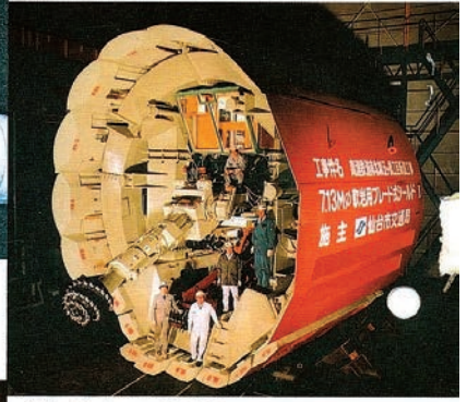
写真-7 シールド施工② 大断面シールドの掘進作業を自動制御
