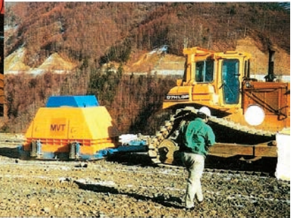
写真-9 盛土締固めロボット タンピングの効果にもとずき振動数、振幅、締固め回数などを自動制御し、所要の締固め度を得る
