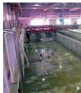
大規模水理模型実験水槽(短辺10m×長辺50m×深さ2.8m)
