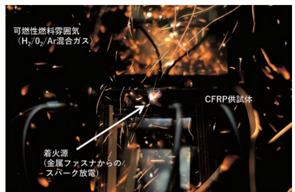
図2 CFRP 航空機供試体を用いた雷撃試験によるスパーク着火の様子
