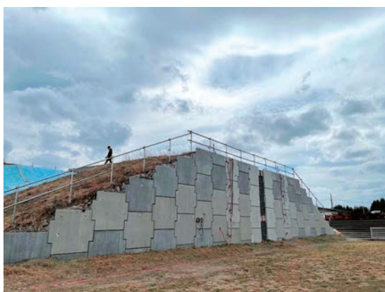
図1 実大試験補強土壁とX線CTスキャンにより可視化した補強材引抜き時の地盤内部構造
