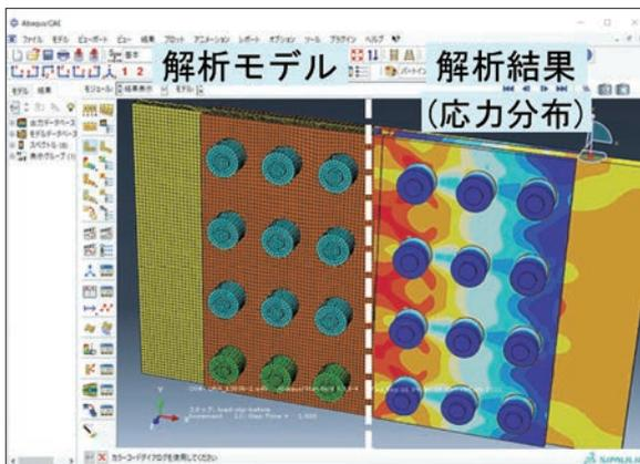
図2 FEM 構造解析の例(継手)
