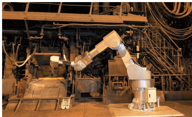
電気炉向け测温サンプリングロボット 「Spco-ROBO KNIGHT」
