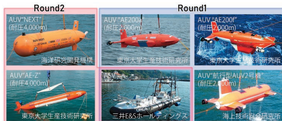
図3 Shell Ocean Discovery XPRIZE で使用したロボット
