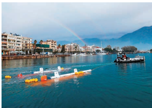
図4 ウエットテスト中に行った曳航試験
