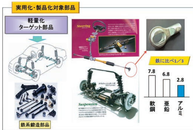
図9 新アルミ鍛造品のターゲット自動車部材と軽量化
