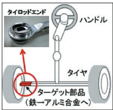
図8 新アルミ鍛造品のタイロッドエンドへの適用事例
