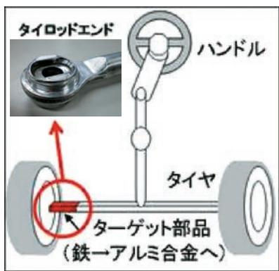
図8 新アルミ鍛造品のタイロッドエンドへの適用事例
