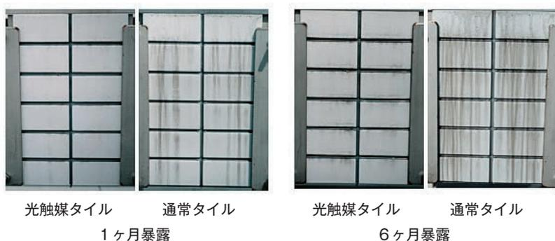
図3. 光触媒タイルと通常タイルの防汚性に違い (TOTO 関連製品のホームページより)
