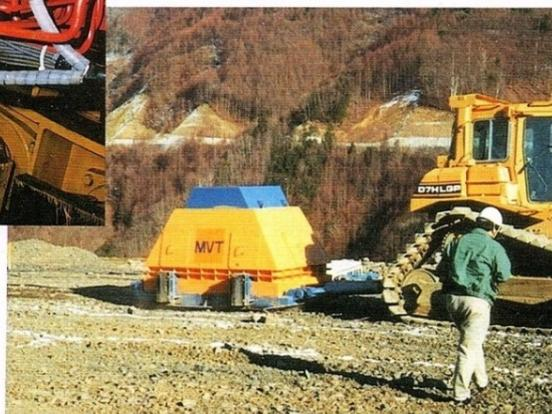
写真-9 盛土締固めロボット
